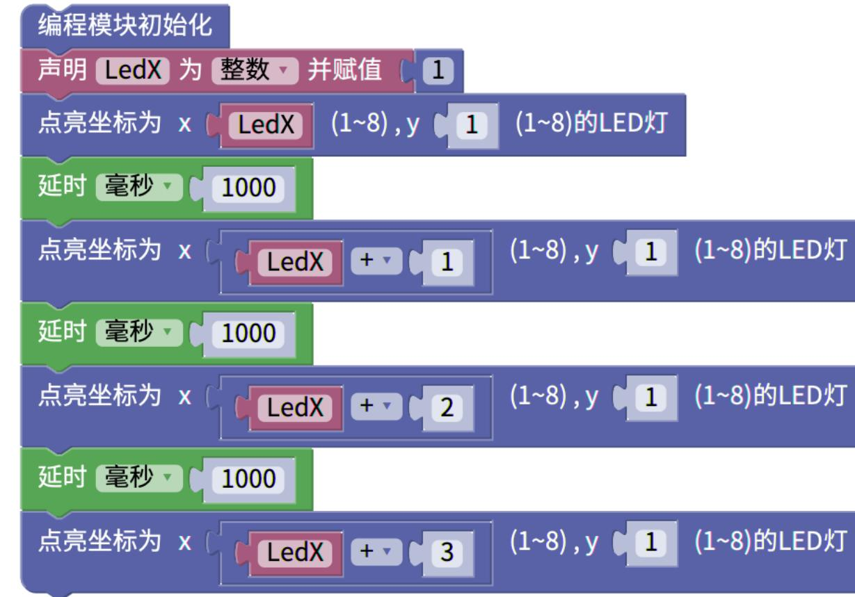
在第六课中，我们使用了变量来代替LED的X坐标，但按照上图的程序，我们多次使用了变量，十分繁琐，那有没有什么简单的方法呢？
